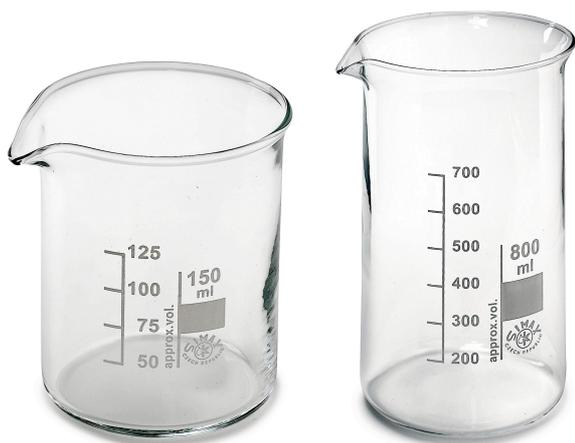
È un contenitore di forma cilindrica con un beccuccio, di varia capacità. Adatto a svariati usi: dalla preparazione delle soluzioni al riscaldamento. Per chiuderli si possono usare vetrini da orologio (vedi avanti) quando caldi, altrimenti Parafilm®.
