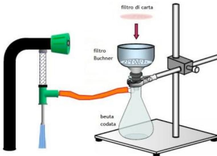
Utilizzo di un imbuto Bruckner per “filtrazione a pressione ridotta” mediante pompa ad acqua per mezzo della quale si crea un vuoto parziale all’interno della beuta che determina l’apirazione del liquido contenuto nell’imbuto.
