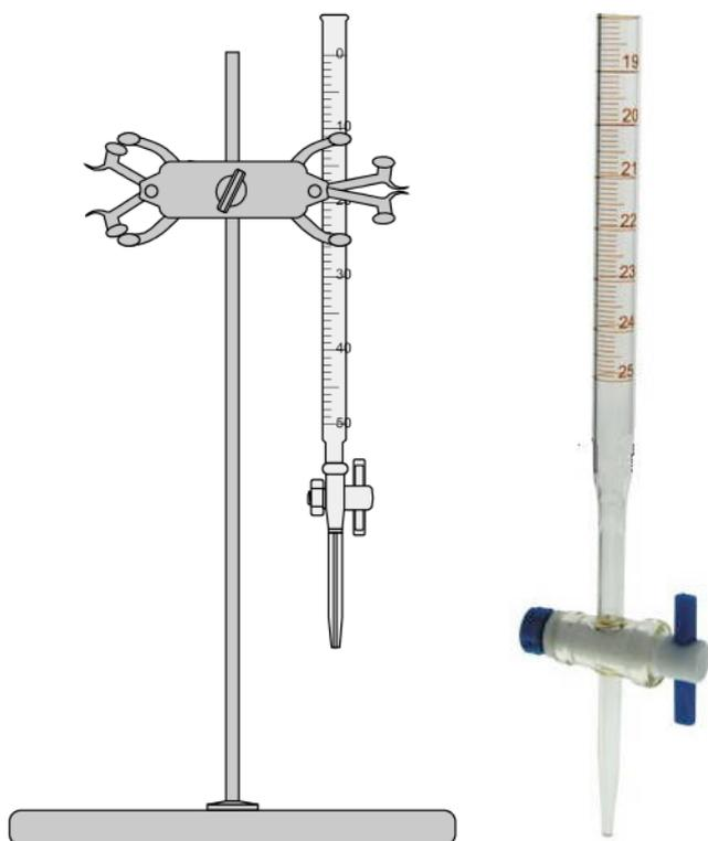
Viene usata per trasferire in modo accurato (errore  $\pm 0.1\%$ ) una quantità variabile di soluzione. Dotata di un rubinetto in vetro o teflon, viene posta sul bancone da lavoro utilizzando l'apposito stativo e pinza ragno.
