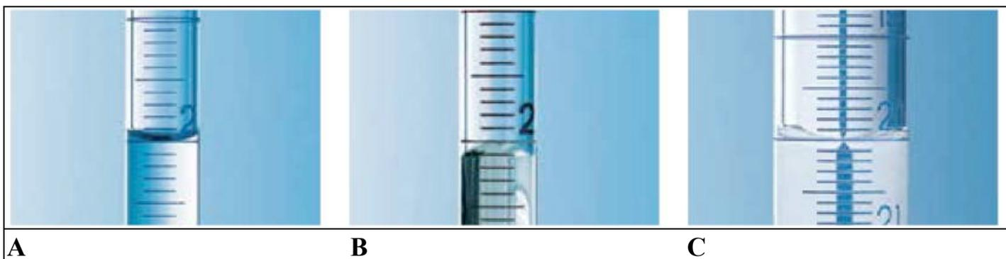
Se il menisco è curvato verso il basso (A), si deve leggere il volume nel punto più basso dello specchio del liquido. In tal caso, il punto più basso del menisco deve toccare l'angolo superiore della linea di graduazione.
