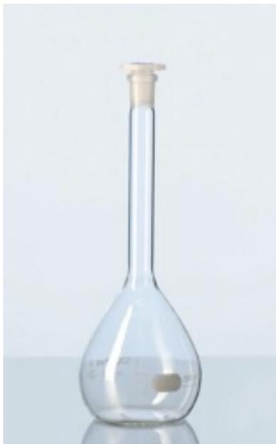
Il matraccio è un pallone a fondo piatto con collo lungo sul quale viene indicato il livello del liquido da raggiungere perché il volume corrisponda esattamente alla capacità indicata.
