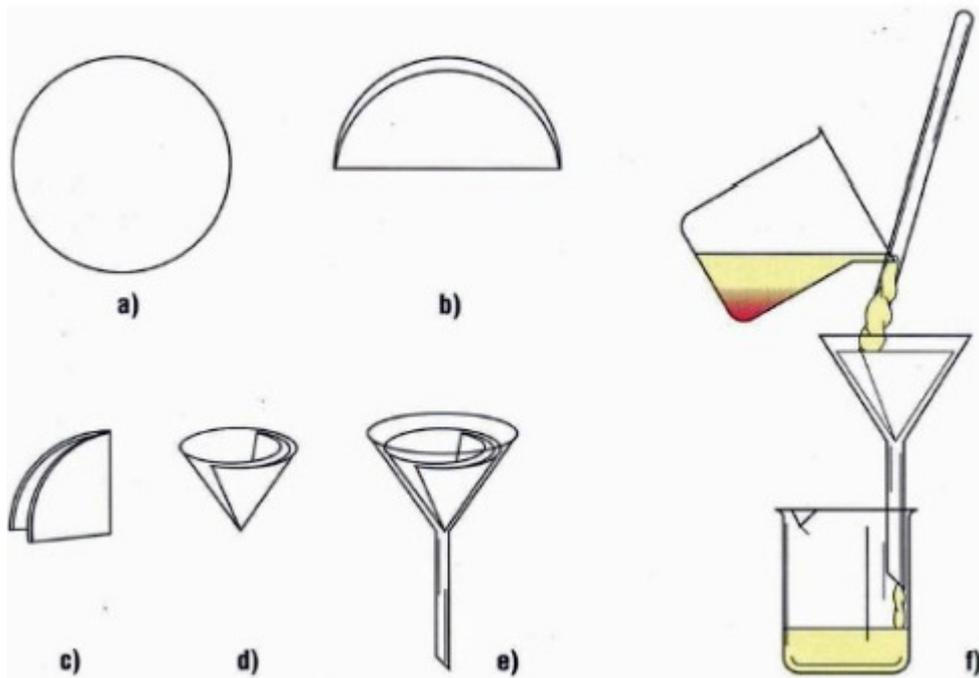
In figura: “Filtrazione per gravità” di un miscuglio eterogeneo con utilizzo di carta da filtro opportunamente ripiegata nell’imbuto. Si noti l’utilizzo di una bacchetta di vetro per convogliare il liquido versato.
