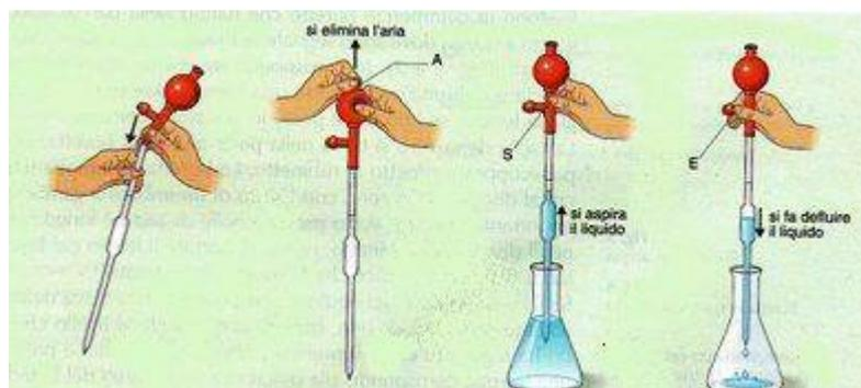
Per l'aspirazione e la successiva erogazione del liquido viene usata insieme alle pipette la Propipetta (detta anche palla di Peleo o porcellino).
