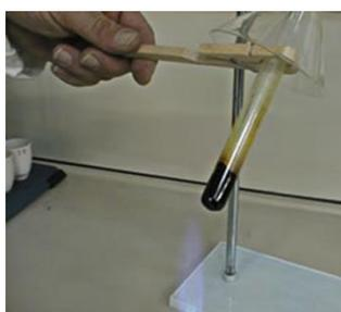
6. Sempre rimanendo sotto cappa, riscaldare la provetta con il rame II° nitrato fino alla sua decomposizione in rame II° ossido. Continuare il riscaldamento fino a quando tutto il composto verde-azzurro è diventato di colore nero (trasformazione completa in rame II° ossido) e dalla provetta non escono più vapori rossi (ossidi di azoto). La seguente reazione che avviene è:
